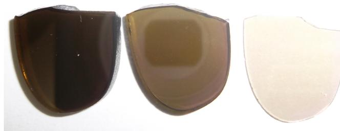
**Figura 3.8:** Fotografia da superfície das amostras LSCAS-Cr.
