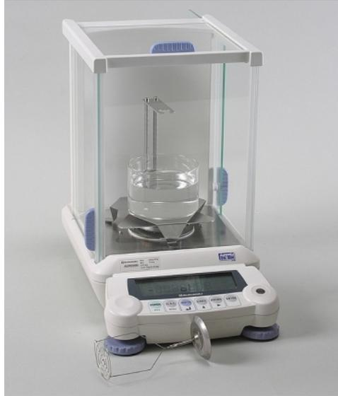
**Figura D.3:** Balança analítica com acessório para medição de densidade [44].
