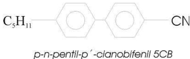
Figura 1.7: Estrutura de um cristal líquido termotrópico.
