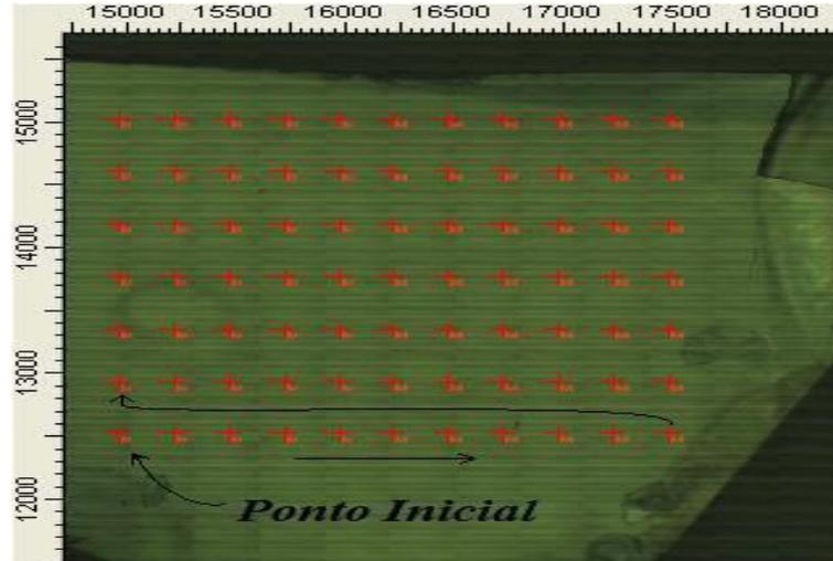
Figura 21: Imagem da amostra CAS.20 feita pelo microscópio acoplado ao equipamento Raman, os pontos vermelhos delimitam a região de varredura e indica a posição onde foi realizada cada medida. As setas indicam a direção seguida durante a varredura.
